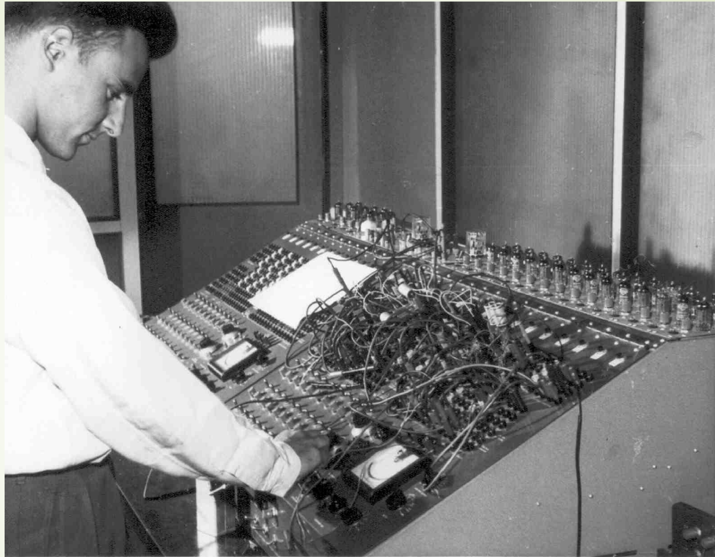
Computador Analógico Heathkit armado en el Laboratorio de Computadores y Servomecanismos siendo operado por Herbert Ohrband (1958).
